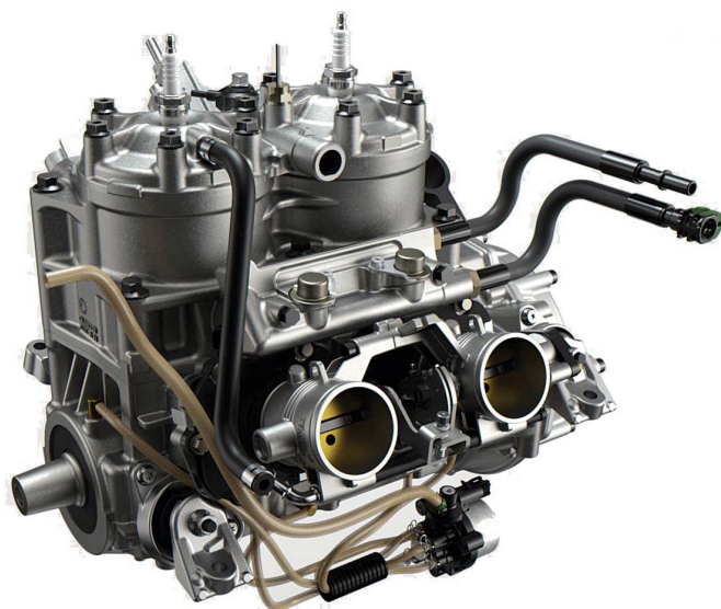
Nydesignad onepiece-cylinder och topp, men bland annat förbättrad kylning, sexbulstat, andra nydesignade avgasportar, utblås, V-force reeds topp och insug.
