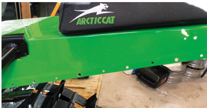
För att montera Skinz lyftbåge med förstärkningskitet så måste man ta bort originalbågen först.
