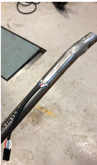
Det sjukt fräna, dyra och råa Rasmusen-styret i titan får här ett par handtagsvärmare monterade.
