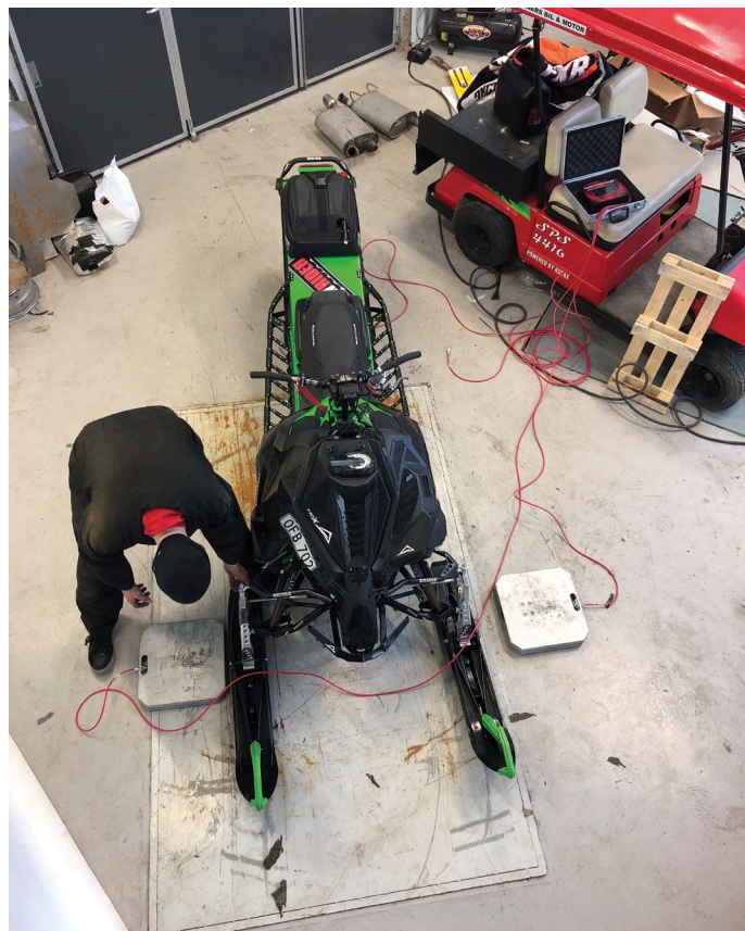
Vi använder oss i vanlig ordning av en riktigt bra och exakt våg avsedd för bilar. Nu väger maskinen 69 kilo vänster fram, 61 kilo höger fram och 110 kilo bak.
