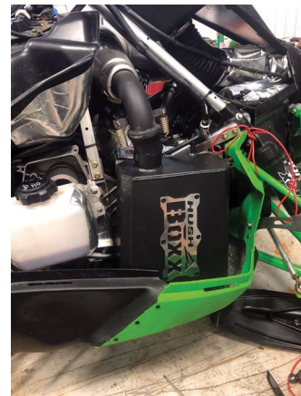
Att inte väsnas är faktiskt prio ett i fjällvärlden. Denna ljuddämpare är så liten att den får plats innanför Heliumkitet. Den låter också extremt lite och ingen reagerar på att ljuddämparen numera är utbytt. Grymt. Den väger drygt 5 kilo mot originalets cirka 9 kilo. Jag måste verkligen säga att denna ljuddämpare är ett grymt alternativ för er som måste byta ljuddämpare av utrymmesskäl.
