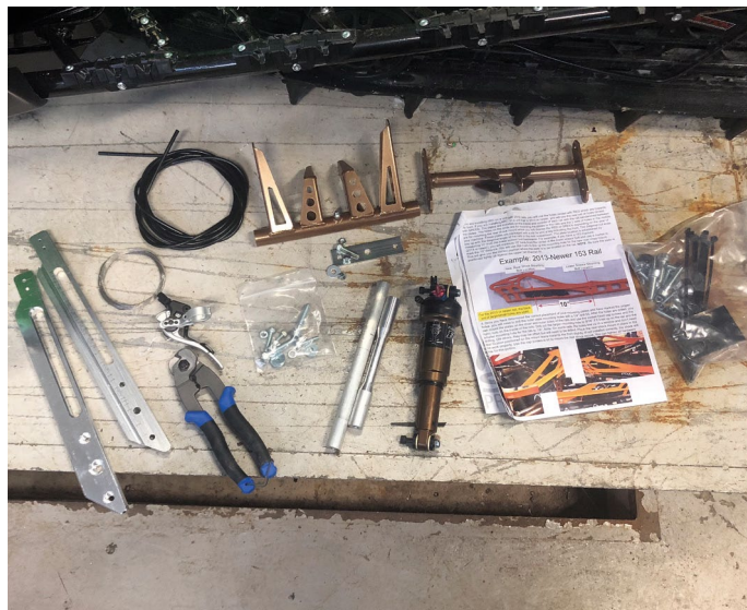
ARC eller Adjustable Remote Coupling är en rolig pryl som tillåter dig att justera maskinens stegringsvillighet med ett reglage på styret. Vi återkommer med denna manick om hur den fungerar i verkligheten.
