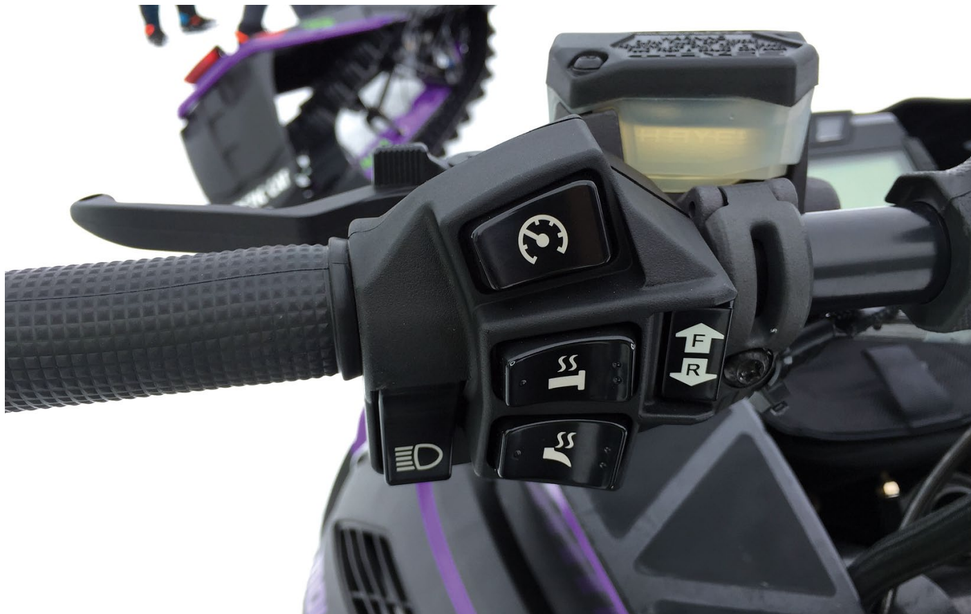
Det är ordentligt upprensat på styret då alla reglage nu sitter i ett block på vänster sida. En ny bromscylinder med nytt kort handtag, smärtare gashandtag och ett dödmansgrepp sitter numera här redan original.
