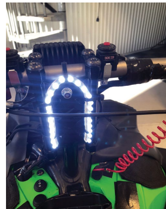
Istället för ett irriterande tjutande när man lägger i backen, lyser numera en ledslinga.
