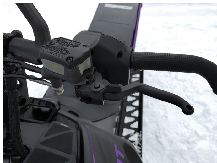
Det är ordentligt upprensat på styret då alla reglage nu sitter i ett block på vänster sida. En ny bromscylinder med nytt kort handtag, smärtare gashandtag och ett dödmansgrepp sitter numera här redan original.
