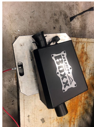
Att inte väsnas är faktiskt prio ett i fjällvärlden. Denna ljuddämpare är så liten att den får plats innanför Heliumkitet. Den låter också extremt lite och ingen reagerar på att ljuddämparen numera är utbytt. Grymt. Den väger drygt 5 kilo mot originalets cirka 9 kilo. Jag måste verkligen säga att denna ljuddämpare är ett grymt alternativ för er som måste byta ljuddämpare av utrymmesskäl.
