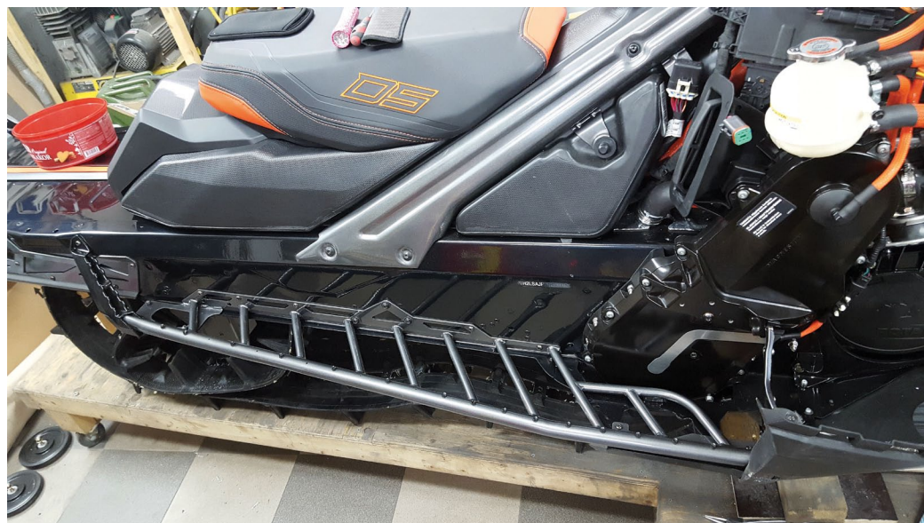
Nya fotsteg blev det också. Modifierade för bättre genomsläpp och bättre fotfäste.
