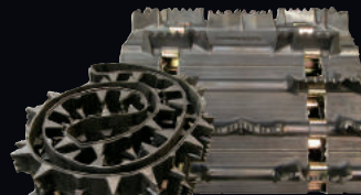
Drivmatta 38x305x44mm Racing Delning 2.86 Öppna fönster (stora fönster) m. skoning på varje. För internaldrift (behövs EJ Non-Slip drivhjul). Shore (hårdhet) 90 Artnr: CAMO9128R Pris: 6 495 kr
