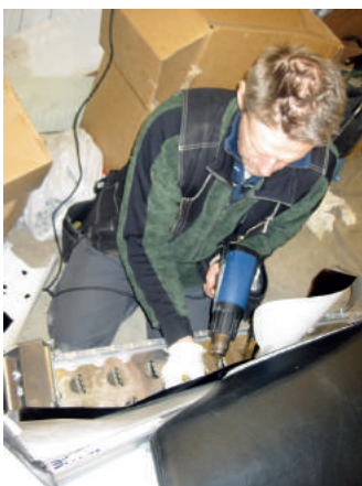
En värmepistol är ett måste för att värma in veck, runt nitarna och skruvhuvuden. Man värmer också över hela dekalerna för att aktivera limmet så att det fäster ordentligt.
