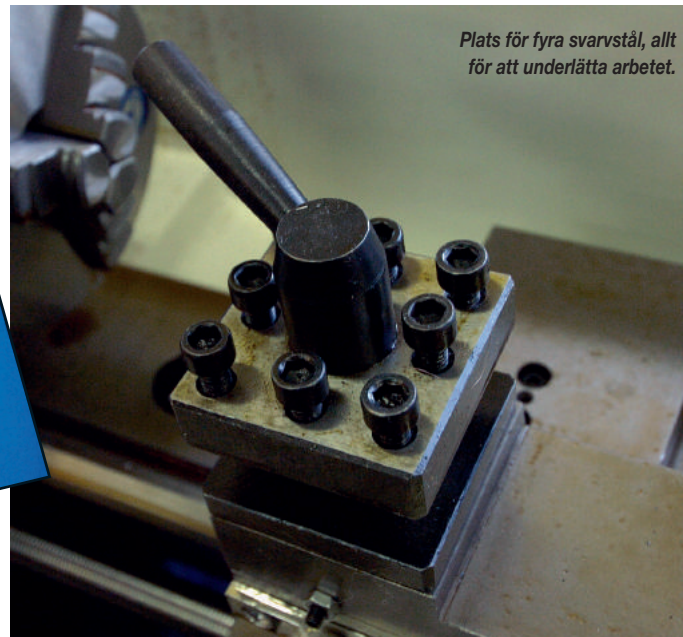
Det kanske inte är storleken det hänger på? Denna mini lathe modell 60206 har ett dubbavstånd på 390 mm och en dubbhöjd på 90 mm, motorn är på 400w. Priset är runt 5000:-
