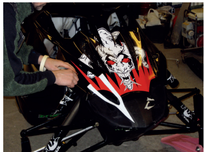
Kniven får sedan göra sitt jobb runt kanterna för att ta bort material som sticker ut.
