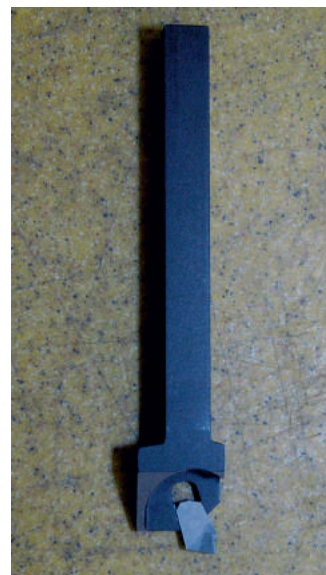
Svarvstål med utbytbara skär är lite dyrare än snabbstål men kanske billigare i längden? En sats kostar runt 1000:-
