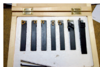
Svarvstål med utbytbara skär är lite dyrare än snabbstål men kanske billigare i längden? En sats kostar runt 1000:-
