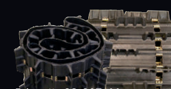
Drivmatta 38x307x44mm Delning 2.52. Öppna fönster m. skoning på varje. För internaldrift (behövs EJ Non-Slip drivhjul) Shore (hårdhet) 80 Artikelnr: CAMO9071 Pris: 5 995 kr
