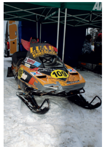
Skicket på maskinerna varierade stort, denna Blizzard 9500 var lagad med en skotermekanikers bästa vän, gaffatej.
