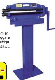
Stabil plåtfalsmaskin som är mycket lämplig för bilbyggare och renoverare. Den kraftiga konstruktionen gör det lätt att tillverka plåtdelar till din renovering.
