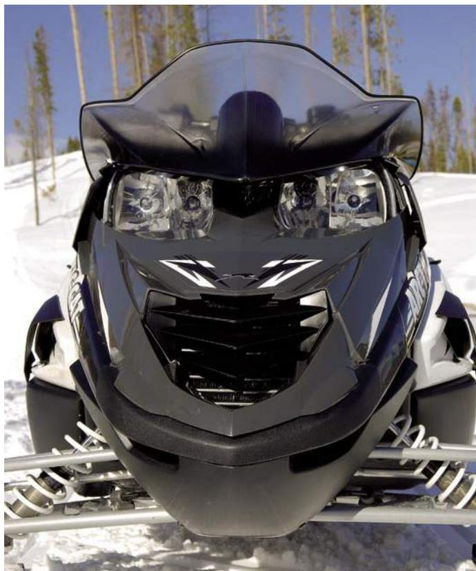
Gillar du svart och koppar så kommer årets sverigeversion passa dig som handen i handsken. Här syns tydligt friskluftsinsläppet till intercoolern som ser till att insugsluften hålls i lämplig temperatur.
