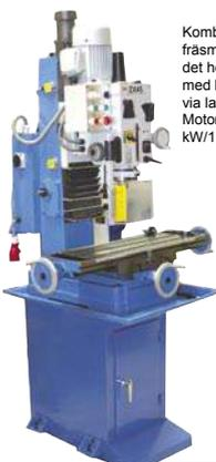
Kombinerad borrar- och fräsmaskin. Fråshuvudet höjes och sänkes med hjälp av hissmotor via laxstjärtsgejdr. Motor 400 V 1,1 kW/1,5 hk
