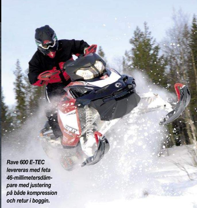
**Rave 600 E-TEC** levereras med feta 46-millimetersdämpare med justering på både kompression och retur i boggin.
