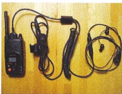
Det här är den ena delen i ett "skoter till skoter" system. Neckmikes konstruktion är enkel och kräver ingen egentlig installation.
