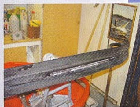
Med riktiga styrstål styr äntligen F7:an.
