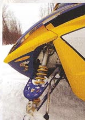
Piggy Back-dämparna är borta och har ersatts av klicker-dämpare runt om. A-armarna är nu gjorda i dyr och lätt chrome molly.
