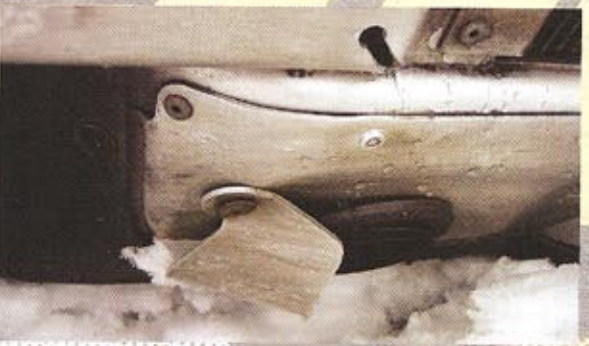
Nu för tiden drar de flesta ut avgaserna i "hjulhuset" fram. Men på den här satt utblåset mer oskyddat under buken.
