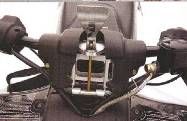
Med sprinten utskjuten för man upp låsningsarmen som lösgör hela styrinfästningen. Nu kan man föra fram eller bak styret och vrida det i rätt läge.
