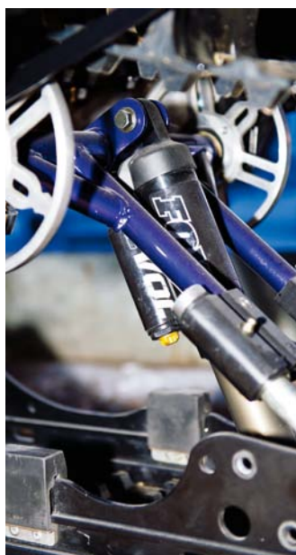
Egentillverkad boggie i "Timbersled stuk", är ca 10kg lättare än original utrustad med Fox Float Evol dämpare.
