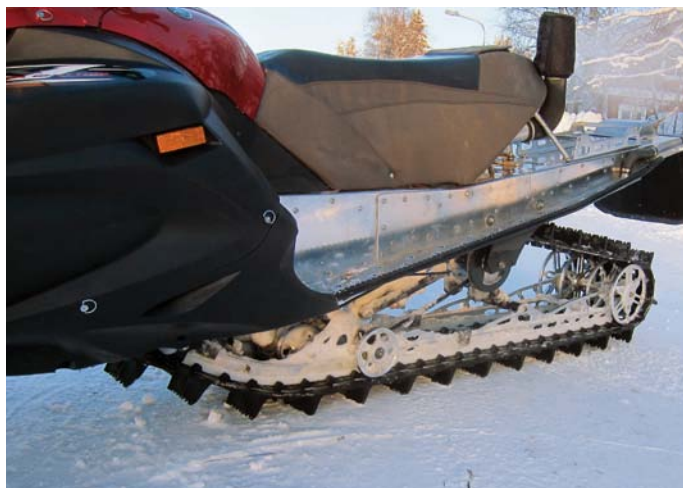
Den numera jättelånga Apexen har full uppsättning av Billet X hjul. Fyra 9" vändhjul fyra bogghjul med den lite större diametern 135mm som minskar maskinens apptit på slidesplast.
