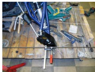
Det krävs en hel del funderande när man bygger en egen framvagn, här är det styrstagen som justeras.
