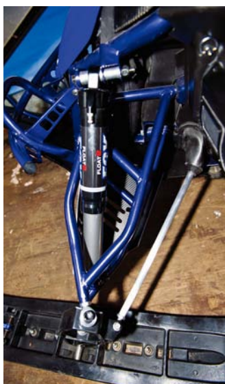
Hela framvagnen är egentillverkad och modifierad, bland annat med pulverlackade spindlar som skall minimera "bumpstear" och camberändringar under fjädring.
