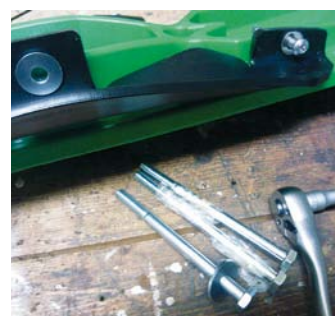
När man monterar Thrusters behövs det längre skidbultar, vilka medlevereras.
