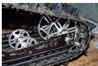
Alu.hjul med Yamaha-logga som jag designat och tillverkat själv. Egentillverkad offsetaxel och 9" vändhjul som är ihopkopplade.
