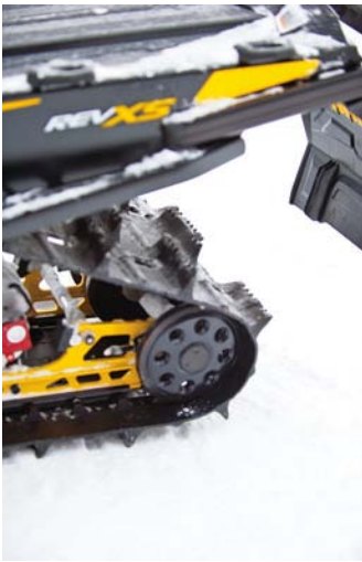
PowderMax-mattan ger bra med fäste vid acceleration, lite sämre vid inbromsning.
