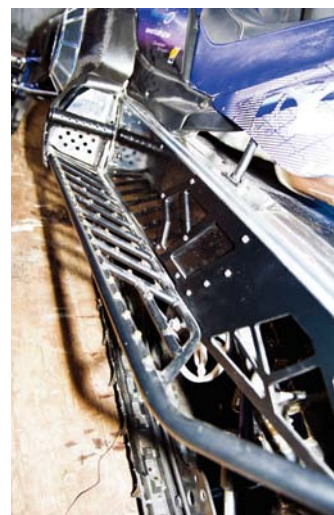
Egentillverkade fotsteg i rörkonstruktion med skruvdubb, betydligt längre än original, pulverlackade.
