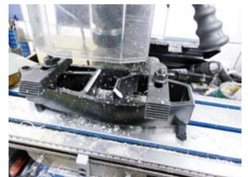
Här fräser Christian till kanterna på spindeln så att dom ska gå fria från A-armen.
