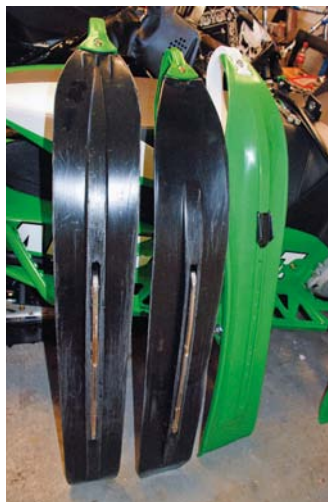
Tre väldigt olika utformning på kölarna, från vänster står AC Sno Pro 600 XC -09, AC RR -13 och Curve XS.
