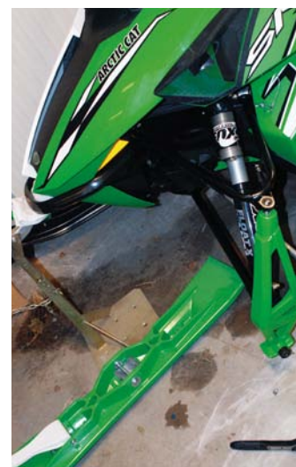
Monteringen gick smärtfritt även om lyftöglan krävde lite våld. Se till att matan är rak och kolla toe-out när du ändå håller på.
