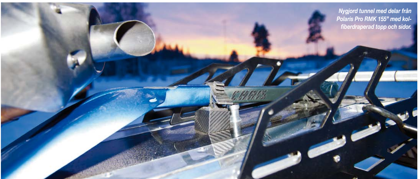
Det krävs en hel del funderande när man bygger en egen framvagn, här är det styrstagen som justeras.
