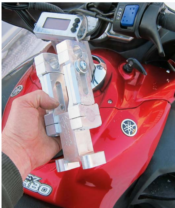
En justerbar styrhöjare ska också monteras, jag ska bara fixa ett bra fäste till min MCX display. Billet X gör en mycket stadig höjare som inte ger känslan av att flexa i något läge, vissa justerbara höjare är för vecka för min smak.
