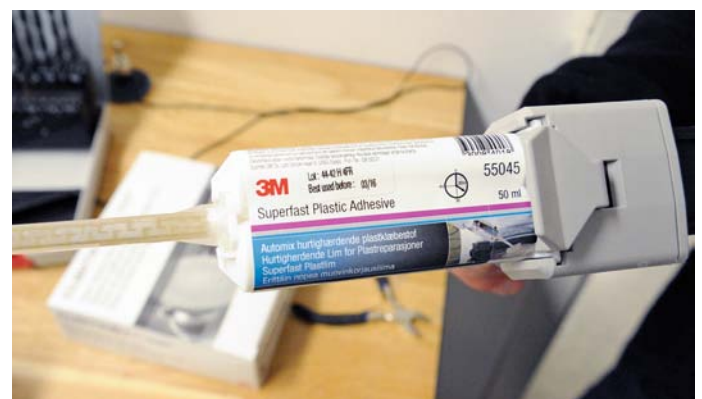
Ett snabbhärmande plastlim från 3M användes, nummer 55045.
