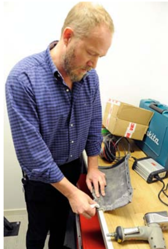
Rengöring av ytan är väldigt viktigt för att få ett bra resultat innan applicering av limmet, här används 3M VHB ytrensingsmedel. Sen sprayar man på 3M vidhäftningspromotor spray 05917 och väntar tio minuter.
