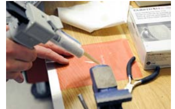
Lägg på plastlimmet på platsfilmen.
