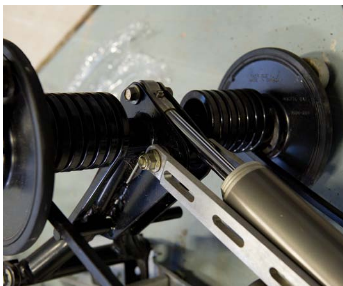
Ovala hål och sprickor i boggiskenorna är mer en regel än undantag på riktigt gamla maskiner. Bli inte förvånad om du hittar dessa också på en nyare maskin.
