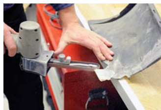
Efter tio minuter kan man gå på och slipa plasten.
