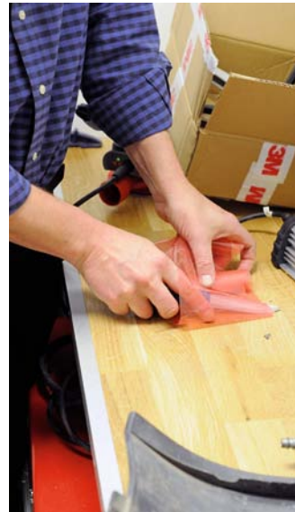
Skär en plastfilm i en lagom stor bit så du kan forma limmet, här används 3M plastfilm 04903.
