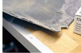
Här ser man att ytan som ska lagas har slipats som ett "V", så det finns plats för den nya plasten på båda sidor av materialet.
