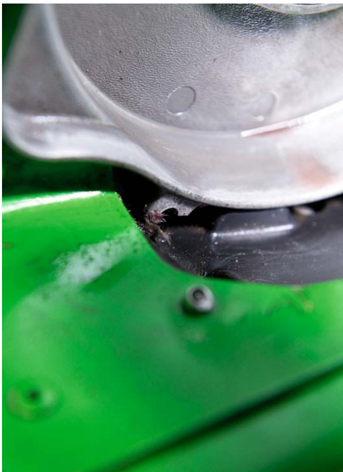
Ovala hål och sprickor i boggiskenorna är mer en regel än undantag på riktigt gamla maskiner. Bli inte förvånad om du hittar dessa också på en nyare maskin.
