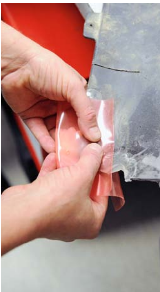
Sen formar du limmet till önskad form med hjälp av plastfilmen, härdningen börjar nästan direkt.
