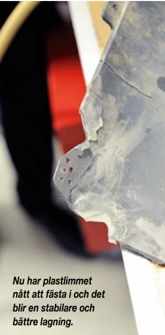
Rengör ytan som ska repareras med 3M VHB ytrensingsmedel. Sen kan man börja slipa tunt på det området som ska repareras, så det finns plats för plastlimmet.
