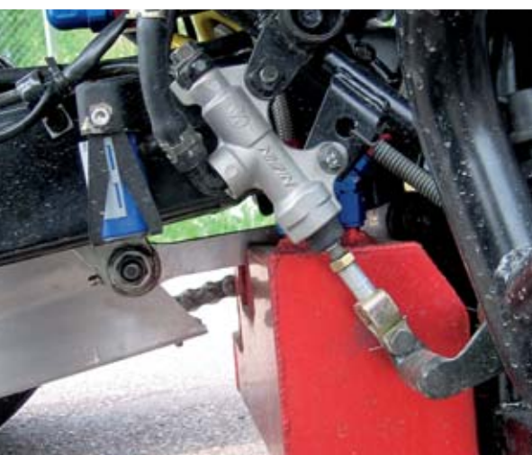
En trevlig catchtank ser till att pumpen alltid har bensin att pumpa fram till spridarna.
