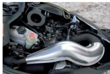
Polaris fina 140-hästares 700 HO Cleanfire hjälpte Polaris att förra säsongen ta hem den åtråvärda Bästa Ledskoter-testen. I år har den en ny typ av kolv med bara en kolvring och en ny oljepump.
