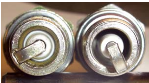
Här syns tydligt skillnaden mellan ett varmt och ett kallt stift. Det vänstra har en betydligt kortare keramikspets eller isolator och har då ett högt värmetal och benämns som ett kallt stift. Det högra har en lång keramikspets och på grund av det leder det bort värmen sämre och blir då följaktligen ett varmt stift. Det är på detta sätt tillverkarna styr värmetalet på ett tändstift.
