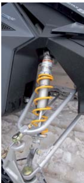
Alla de tre nya MX Z-XP har fullt renoveringsbara aluminiumdämpare med clickerfunktion i framvagnen.
