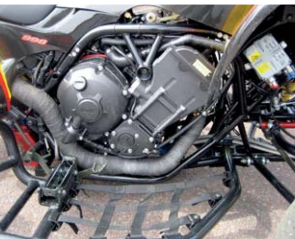
Yamahas R1-motor har fått sig en liten frisering och ger i Dahlbäck's utförande hela 189 kusar. Visst är det trevligt när hela fordonet väger cirka 220 kilo?
