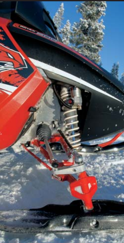
Nu sitter den extrema framvagnen A-VRC+ på samtliga Lynx sportmaskiner.
