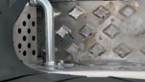
Nytrö har fått rik- tigt rejäla fotsteg med ett mycket bra grepp. De relativt små hålen förhindrar dock en bra rensning från snö och is.
