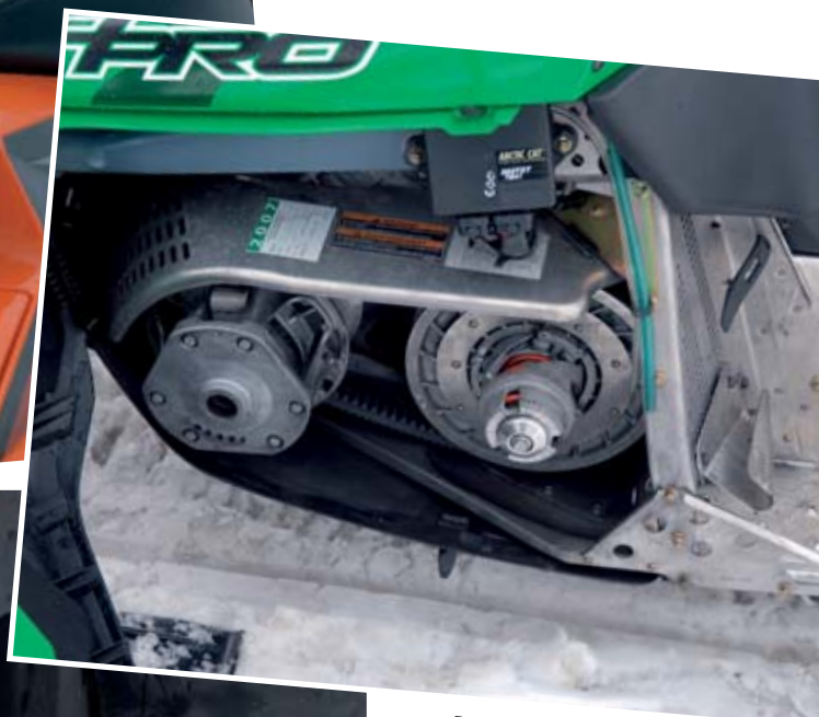
Diamond drive är på många sätt en underbar uppfinning. Det finns dock en begränsning som blivit tydlig just i år. För att Arctic Cat någon gång skall kunna placera sin sekundärvariator mer likt Ski-Doo på REV-XP så kommer dom att behöva ett betydligt längre växelhjul, vilket blir svårt om man bara vill använda sig av två drev som jobbar mot varandra.
