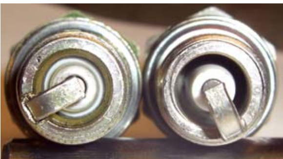
Här syns tydligt skillnaden mellan ett varmt och ett kallt stift. Det vänstra har en betydligt kortare keramikspets eller isolator och har då ett högt värmetal och benämns som ett kallt stift. Det högra har en lång keramikspets och på grund av det leder det bort värmen sämre och blir då följaktligen ett varmt stift. Det är på detta sätt tillverkarna styr värmetalet på ett tändstift.
