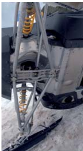
Alla de tre nya MX Z-XP har fullt renoveringsbara aluminiumdämpare med clickerfunktion i framvagnen.
