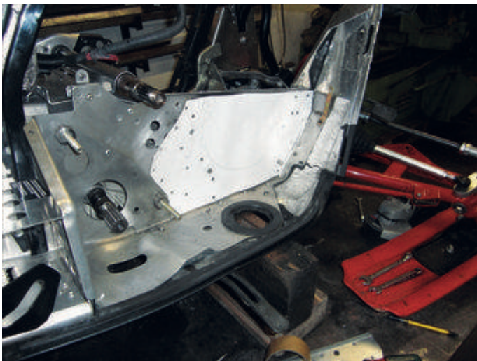
Då motorn är 129 millimeter längre på MAG-sidan fick det lov att kapas lite. Efter att en mall gjorts var det alltså dags för sågen.
