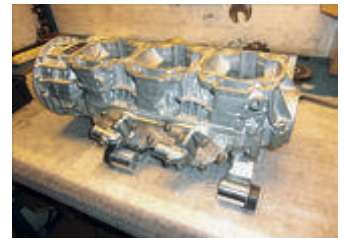
Nya snygga motorfästen där originalbussningarna pressades på plats tillverkades.
