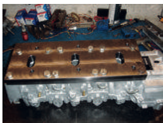
Nu vore det väl fan om något skulle slå sig med en redig stressplatta i stål och vevaxeldummy på plats.
