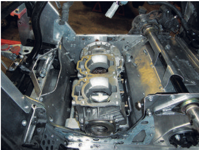
Då motorn är 129 millimeter längre på MAG-sidan fick det lov att kapas lite. Efter att en mall gjorts var det alltså dags för sågen.
