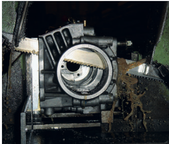
Efter lite tankeverksamhet sattes så bladet i Rotax 800:n och allt gick som en dans tills bladet nådde styrstiftet som fixerar blockhalvorna. Vilket resulterade i ett tandlöst blad.
