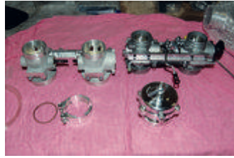
Nytt 50mm spjällhus (t v) med dubbla spridare per cylinder tillsammans med Tial 50mm dumpventil.
