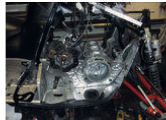
En otroligt snygg förstärkning i 12 millimeters aluminium tillverkades.
