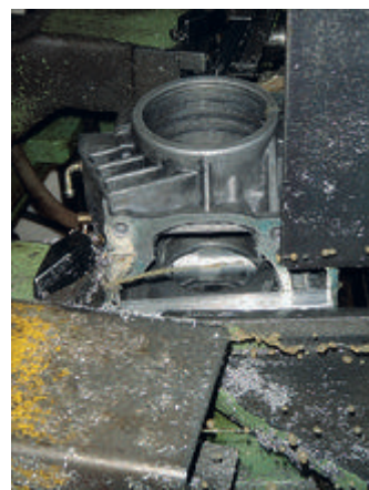
Efter lite tankeverksamhet sattes så bladet i Rotax 800:n och allt gick som en dans tills bladet nådde styrstiftet som fixerar blockhalvorna. Vilket resulterade i ett tandlöst blad.
