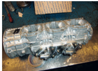
Ett nytt snyggt lock till de dubbla vattenpumparna frästes för att få det att stämma.
