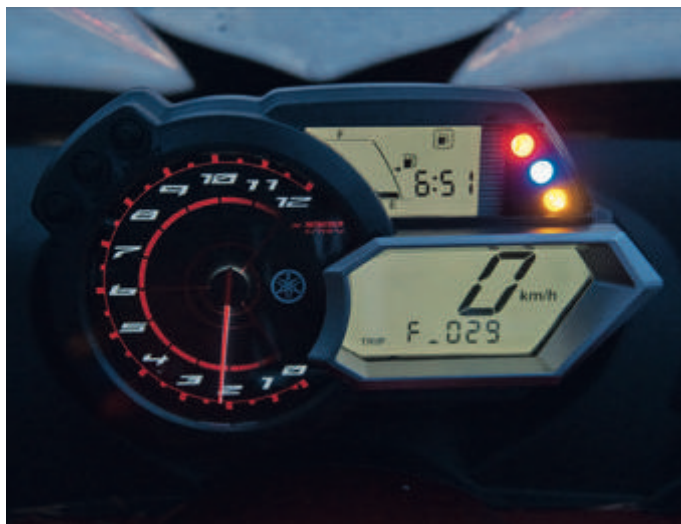
Tydlig display med allt som behövs. F_029 betyder att man har kört 29 kilometer sen varningen om för låg bränslenivå. Första nollan kunde man egentligen ta bort för skotern går exakt 30 kilometer på reserven. Tro mig, jag har testat och gått hem.
