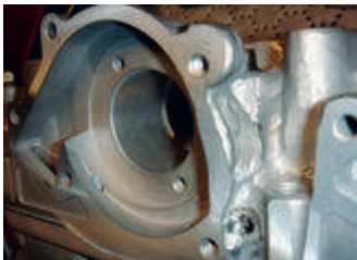
Fästet för den ena av de två vattenpumparna fick byggas upp igen med hjälp av en stadig hand.
