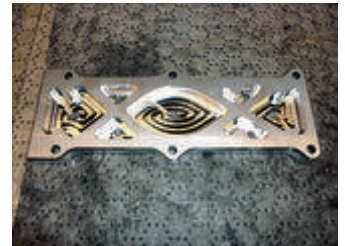
För att inte blocket ska vrida sig runt sin egen axel likt ett pinnbröd skapades en rejäl förstärkningsplatta i 20 millimeters aluminium.
