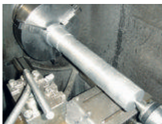
En vevaxeldummy svarvades till med lagerlägen och allt. Den användes sedan för att fixera blocken vid svarvning och svetsning.
