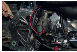
Därefter monterades oljepumpen och ledningar drogs färdigt för både olja och vatten. Även luftintaget är färdigt och det börjar se ganska klart ut!
