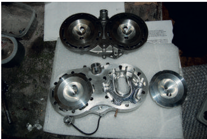
Den efterbeställda CPC-lågkompstoppen med sina lösa förbränningsrum anlände med expressfrakt i rättan tid för montering.
