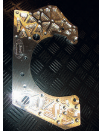
En otroligt snygg förstärkning i 12 millimeters aluminium tillverkades.
