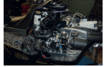
Därefter monterades oljepumpen och ledningar drogs färdigt för både olja och vatten. Även luftintaget är färdigt och det börjar se ganska klart ut!
