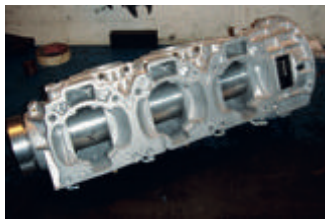
Klart för svetsning efter ett evigt blåstrande och slipande. Kan du se skarven?
