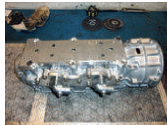
För att inte blocket ska vrida sig runt sin egen axel likt ett pinnbröd skapades en rejäl förstärkningsplatta i 20 millimeters aluminium.
