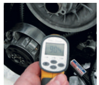
Då man hört en del om remproblem mätte jag temperaturen på min rem.
