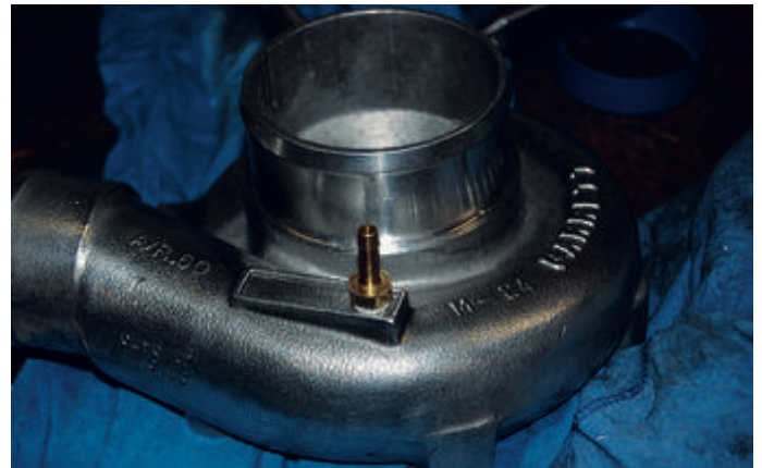
I kompressorhuset på den nya Garrett 2860 turboaggregat borrades och gängades en liten nippel. Den går sedan till en "boost controller", som är en manuell laddtrycksstyrning där man kan justera laddtrycket utan att ändra wastegatens läge.
