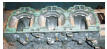
En ny packning med tjockleken 1,5 millimeter för att få rätt porttider skars till.
