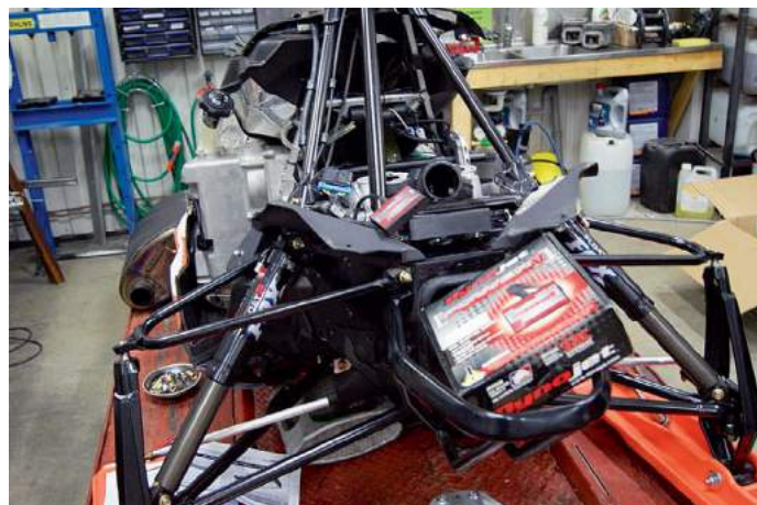
Att bestycka med hjälp av en PC istället för ett finger uppe i vädret och en burk med munstycken är betydligt bättre.
