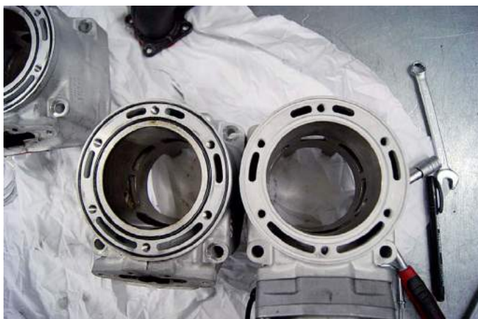
Visst är skillnaden såpass stor att man ser den med blotta ögat. För dig som inte har den minsta känsla för håll kan vi säga att cylindern till vänster är original.
