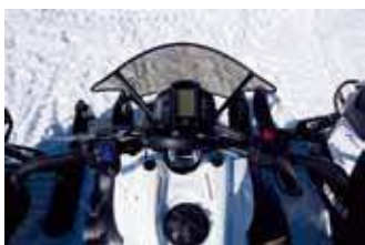
Hela paketet med ruta och instrument följer med styret när man rattar Phazern.
