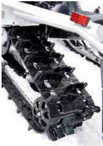
M-Ride står med en 4115 millimeter lång Ascent-matta med 57 millimeters kammar.
