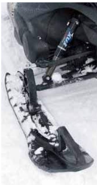
Dom två pråmarna man monterat ser till att skotern flyter fram och luftdämparna från FOX justeras enkelt till önskad hårdhet.
