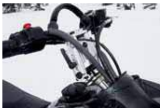
Tack vare hur den justerbara styrhöjaren sitter monterad kan man nu även få styret i önskad vinkel.
