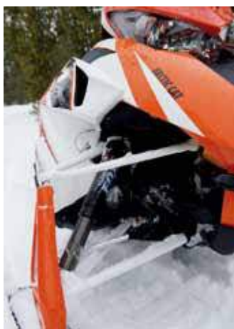
Sno Pro betyder som vanligt att man hoppar upp ett pinhål när det gäller stötdämparna, här i form av FOX Float 2.
