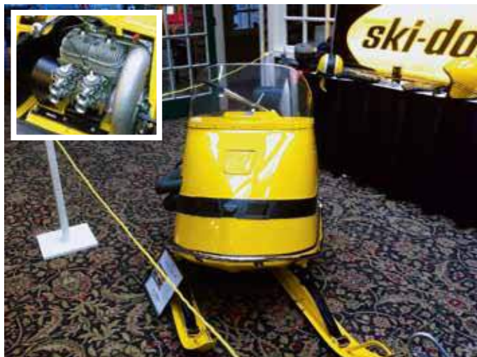
Det här är den första tävlingsskoter som byggdes av Ski-Doo. Den var försedd med skotervärldens första fläktkylda twin - ett koncept som håller än idag. Företaget som tillverkade dessa motorer, som egentligen var avsedda för lantbruksmaskiner, hette Ajax och låg i Montreal Kanada. Foto: Mario Cote
