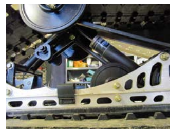
Boggin kommer att flyttas upp i chassiet samtidigt som vi måste hitta ett sätt att göra hela maskinen lägre.
