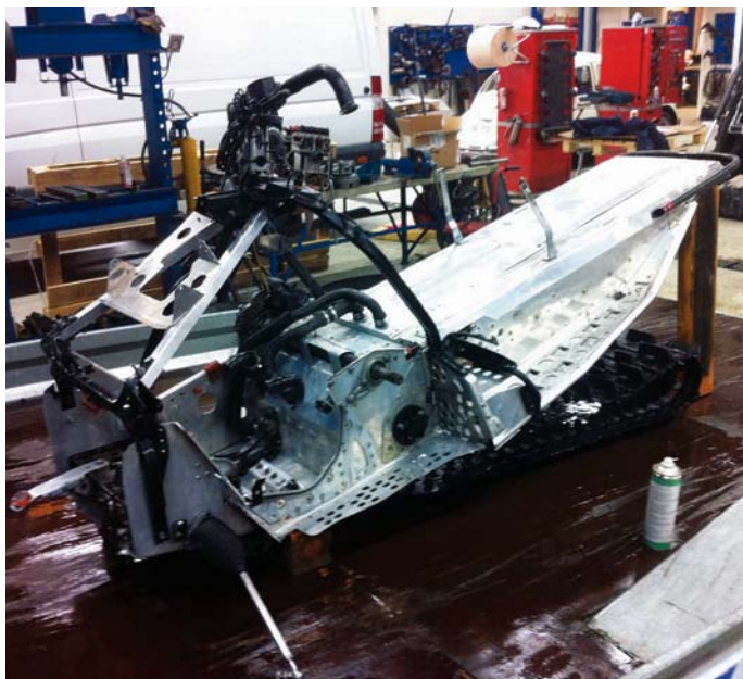
Maskinen plockades ner i småbitar och nitades om innan det var aktuellt för ihopplockning igen.
