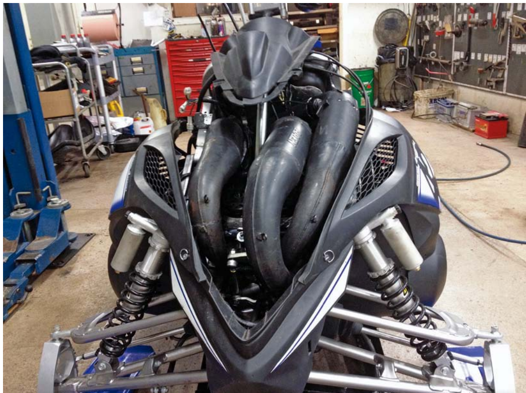
Ont om plats finns det gott om och är det någonting som Nicklas har bränt tid på så är det omdragningen av Aaen-piporna.
