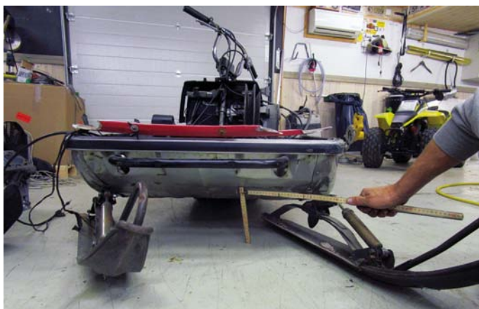
En sak som skapar lite bekymmer är att en modern maskin är betydligt högre i och med en längre fjädringsväg. Just detta kommer att orsaka att vi måste sänka vårt utgångsobjekt rejält i boggin innan vi ens kan tänka på att passa in en framvagn.
