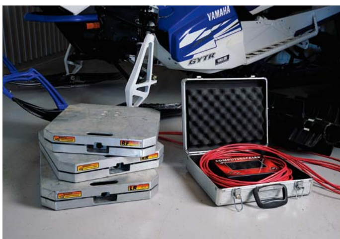
Vi kommer att väga varenda del vi måste ha på den här maskinen för att den ska fungera tillfredsställande. Du kommer att få reda på var vikten sitter original och vad vi antingen kommer att ta bort eller omlokalisera för bättre viktfordelning.
