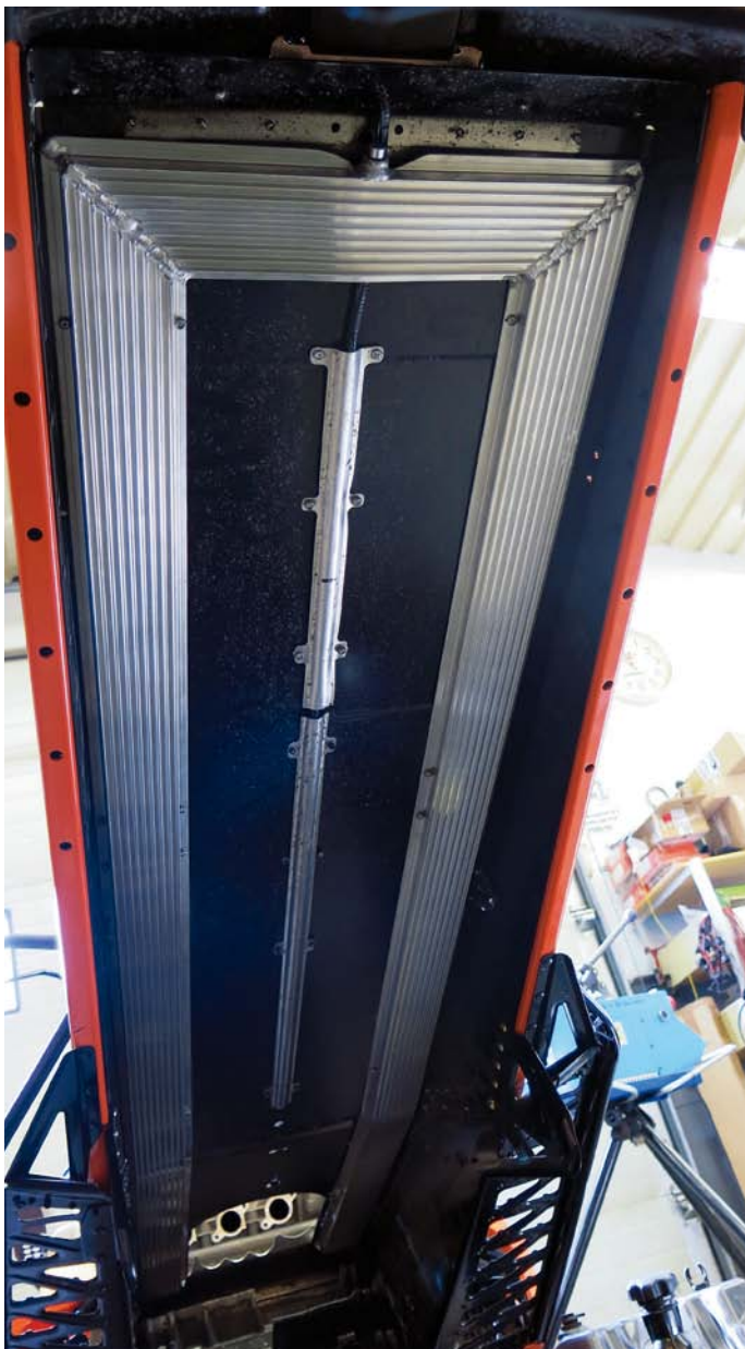
En effektiv "U-kylare" monterad i tunneltaket, med denna på plats behövs inte längre skoterns originalradiator och tunneln kommer numera vara betydligt mer isfri.
