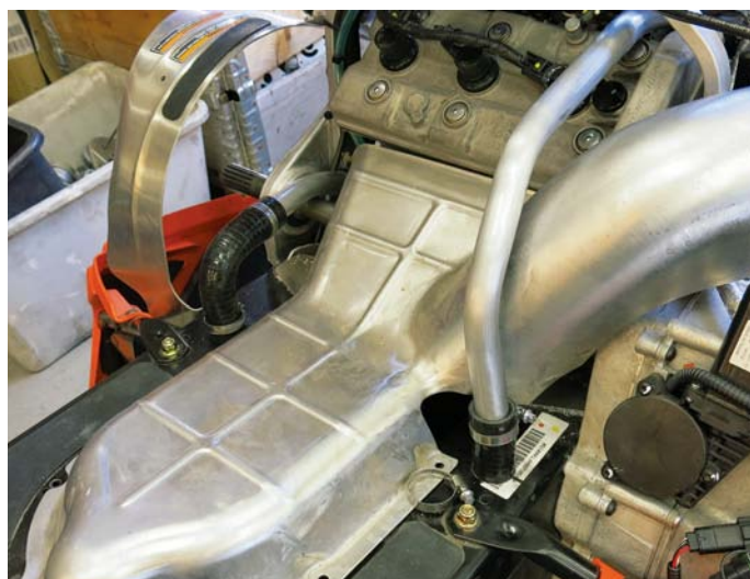
Ny rördragning behövs när man monterar tunnelkyllning i stället för radiator, med bra verktyg kan man få det riktigt fabriksliknande!
